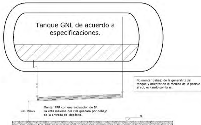
Figura 2: Montaje del PPR del depósito
